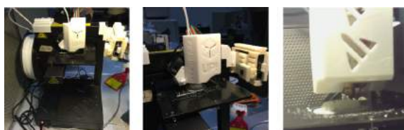
図 10 AttachCam を小型 3D プリンタ (UP Plus 2) に固定した様子と撮影画像 (右)
