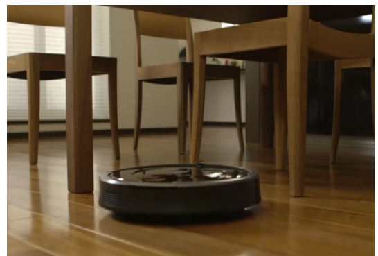
図 1 iRobot 社の Roomba の利用例. 細かな障害物が多い環境だと不具合が起きやすい.
