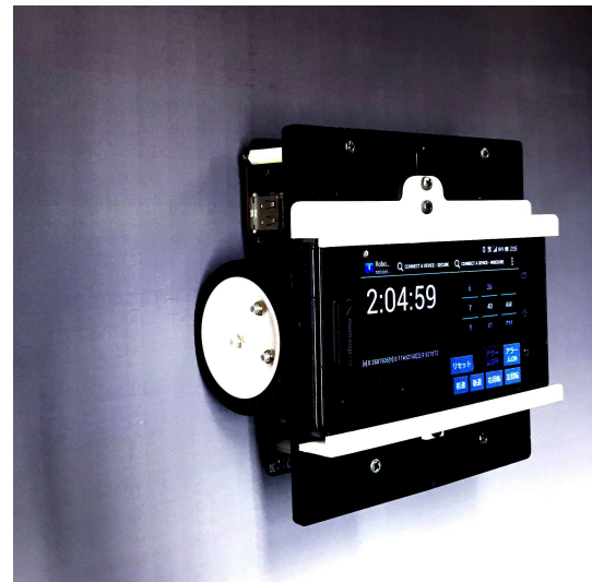
図 2 RoboClock の外観。グラデーションパターンの壁紙を張り付けた壁面上で動作する。
