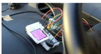
図 1. 既製品のマイコン／センサを車内に設置した事例。固定が難しく、外観も損なう。
