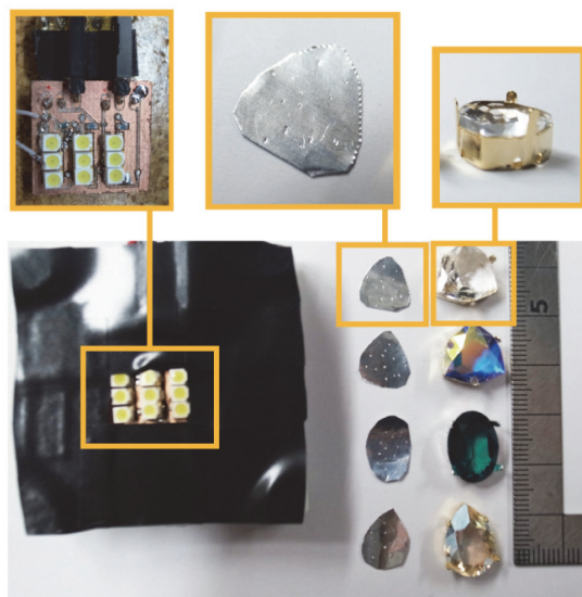
図 3 予備実験に使用した機器／素材. 左から LED アレイ, スリット入り遮光紙 (銀紙), スワロフスキーと石座.
