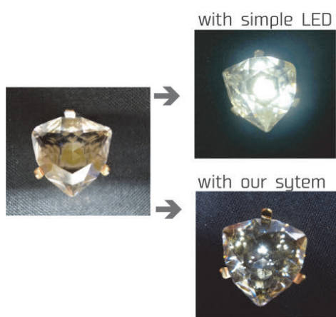
図 2 下部に LED を配置した透明なジュエリーパーツ (図左), スリット無しで LED を点灯 (図右上), スリットを介して LED を点灯 (図右下)。
