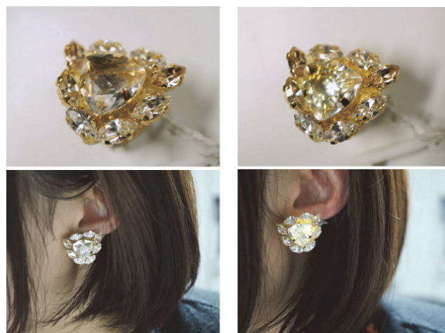
図6 イヤリング型デバイスの外観。上段：装飾部のLED消灯時(図左)と点灯時(図右), 下段：デバイスを身に着けた状態でのLED消灯時(図左)と点灯時(図右)。
