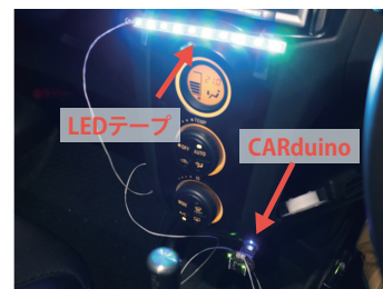
図 9 LED テープを車内に設置した際の例
