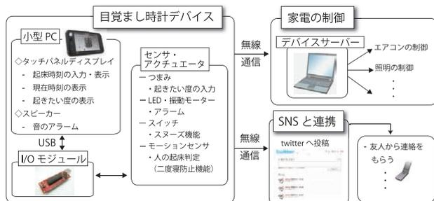
図 4 MediAlarm のシステム構成
