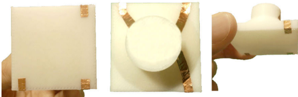
図 8 立体形状のつまみ。左：底面，中央：俯瞰した面，右：側面。底面に 2 次元コードを接着させていない状態。
