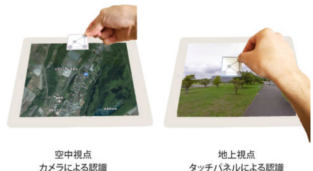
図 7 視点の切り替えが可能な地図アプリケーション。マーカを浮かせた状態と接地させた状態で、Google マップと Google ストリートビューを切り替える。
