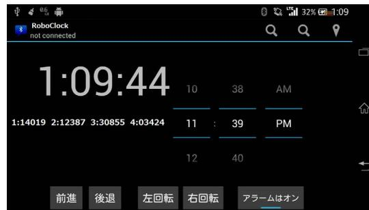
図6 試作中のデモのAndroidアプリの外観。時計表示、ボタン操作によるWallBotの制御、フォトリフレクタ/加速度センサなどの状態表示等の基本機能を備え、アラームオン時には移動目覚まし時計として動作する。
