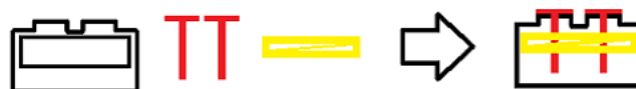
図3 ブロックの構成。白はブロック部、赤は電極部、黄は基板部を表す。
